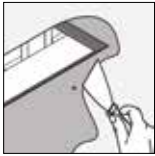
Cadre d'encastrement trimless
